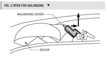
TO OPEN, PUSH THE LEVER TO THE RIGHT AND UP. TO CLOSE, PULL LEVER DOWN.
